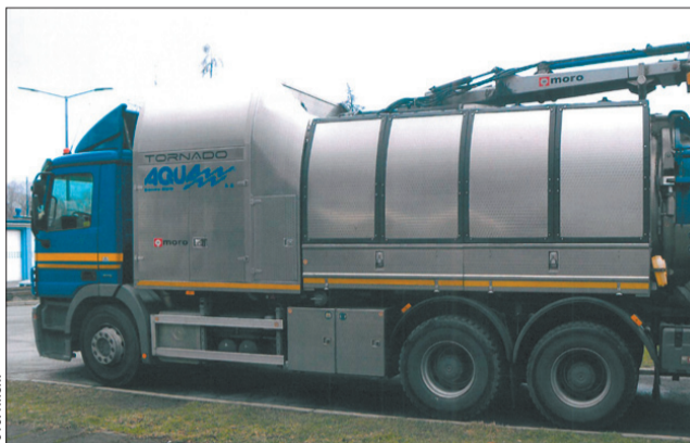
Tylko przy użyciu specjalistycznego sprzętu możliwe było udroźnienie kanalizacji zapchanej materiałami budowlanymi.
